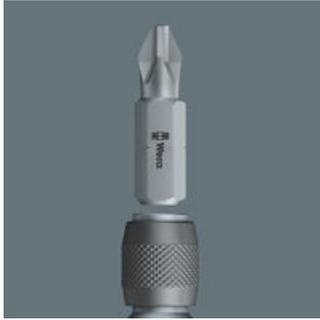
Wera Schnellwechselhalter stellen eine feste, wackelfreie Verbindung zwischen Halter und Bit her. Die Halter sind so konstruiert, dass beim Bitwechsel die äußere Hülse nach vorn geschoben wird und der Bit leicht eingesetzt und entnommen werden kann.
