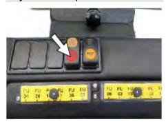
Manuaalisen suodattimen puhdistustuksen kytkeminen päälle.
