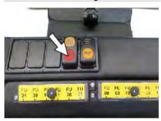
→ Handmatige filterreiniging inschakelen.
