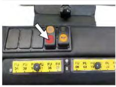
→ Включване на ръчното почистване на филтъра.
