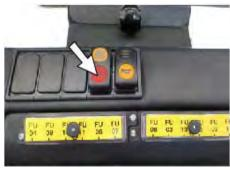
→ Włączyć ręczne oczyszczanie filtra.
