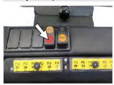
→ Zapnite ručné vyčistenie filtra.
