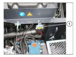
Предохранитель FU 1 (главный предохранитель)
