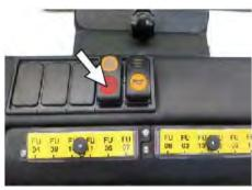
→ Innkobling av manuell filterrengjøring
