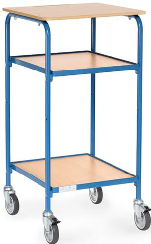
Rollpult aus Stahlrohr und Profilstahl geschweißt, Schraubkonstruktion, pulverbeschichtet, blau RAL 5007. Mit waagerechter Schreibfläche 605 x 591 mm und einer Stiftablege. 2 Ablageböden variabel einschraubbar, 2 Ordnerreihen möglich. Tragkraft pro Boden 50 kg. 4 Lenkrollen mit TPE-Bereifung, Naben mit Gleitlager. 2 Stück mit Feststeller, gemäß der Europäischen Norm EN 1757-3 (Sicherheit von Plattformwagen).
