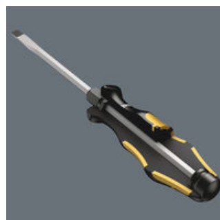
Der Schraubmeißel ist die Lösung, wenn Sie nicht nur schrauben wollen. - Zum Schrauben, Meißeln, Stemmen und Lösen festsitzender Schrauben oder Schraubschellen. Mit integrierter Schlagkappe zur Erhöhung der Lebensdauer und Reduzierung der Splittergefahr. Mit durchgehender Sechskantklinge aus hochwertigem Bits-Material - dadurch verlustfreie Kraftübertragung auch bei Hammerschlägen. Das zähhart vergütete Material verhindert Absplittern oder Bruch der Klinge. Über die integrierte Sechskantschlüsselhilfe können mit Maul- oder Ringschlüssel höhere Drehmomente übertragen werden.
