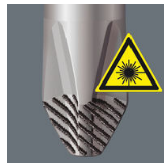
Mittels eng fokussiertem Laserlicht wird eine scharfkantige Oberflächenstruktur erzeugt. Wera Lasertip krallt sich im Schraubenkopf fest und verhindert das Herausrutschen aus dem Schraubenkopf. Bei Schlitz, Phillips und Pozidriv.
