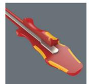
Wera produziert den Kraftform-Griff aus mehreren Materialien mit unterschiedlichen Eigenschaften. Für den wird Kern widerstandsfähiger Kunststoff eingesetzt, der die Klinge auch bei hohen Belastungen sicher hält. Für die farbigen Kontaktzonen wird ein weicheres Material verwendet. Das Material hat höheren Reibungswiderstand und erlaubt die Übertragung größerer Kräfte. Die roten Bereiche mit ihrer härteren Oberfläche verhindern das "Festkleben" der Hand am Griff. Schnelles Umgreifen ist möglich.
