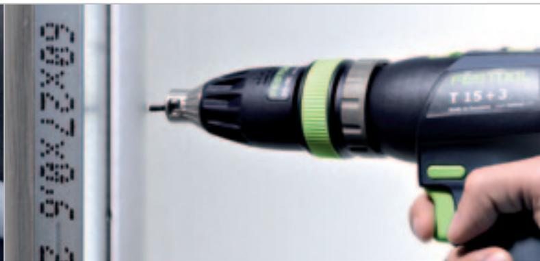
Einfach um die Ecke schrauben. Mit dem FastFix Winkelvorsatz erreichen Sie auch versteckte Schrauben leicht und bequem.
