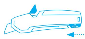
Fixieren Sie den Hebel mit der Sicherung und drehen Sie den Griff so, dass die **transparente Klingendeckung nach oben** zeigt.
