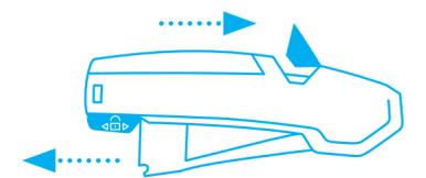
Schieben Sie die Sicherung in die hintere Position, damit sich der **Hebel wieder lösen** kann. **Danach** Klingenwechselknopf in den Griff zurückdrücken und weiterschneiden.
