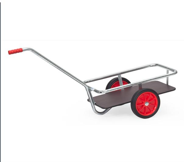
Leichter und sehr handlicher Handwagen. Aus Stahlrohr geschweißt, feuerverzinkt. Für die Verwendung im Außenbereich geeignet. Deichsel anschraubbar. Ladefläche aus wasserfestem Sperrholz. Räder mit Vollgummibereifung. Naben mit Rollenlager. Zerlegte Anlieferung, leichte Selbstmontage.
