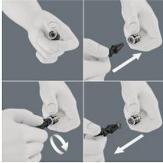
Mit diesem Werkzeug können Schraubenmutter einfach aus Steckschlüsseleinsätzen mit Haltefunktion entnommen werden.
