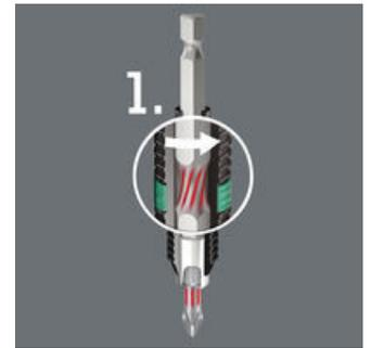
Die im BiTorsion-Halter integrierte Torsionsfeder sorgt für das Abfedern kleinerer Belastungsspitzen (Phase 1). Eine Überlastung dieser Feder wird wirkungsvoll über einen Stützmechanismus verhindert.
