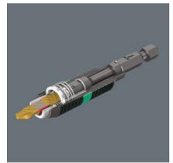
Die Wirkungsweise des BiTorsion-Systems basiert auf der Kombination von zwei schockabsorbierenden Feder-Elementen. Sowohl Bits als auch Halter weisen eine federnde Torsionszone auf, die bei Belastungsspitzen kinetische Energie aus der Abtriebsspitze ableitet.
