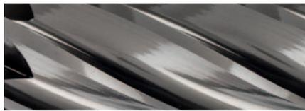
Der Einsatz von Frässtiften mit der HICOAT-Beschichtung HC-NFE von PFERD verhindert das Anhaften von Spänen bei der Bearbeitung von weichen Aluminiumlegierungen. Hierdurch erhöht sich die Standzeit des Werkzeuges und die Oberflächengüte des Werkstückes wird verbessert.
