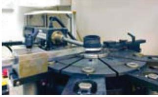
Belastungsverlust-Test in 8 Sektoren
