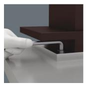
Jeder Anwender kennt seine Winkelschlüssel selbst mit abgesägten bzw. abgeschliffenen kurzen Schenkeln für besonders beengte Verschraubungsfälle. Diese haben den Nachteil, dass sie einen keinen zum Korrosionsschutz mehr an der Trennstelle aufweisen und zum anderen ggf. durch zu hohe Temperaturen beim Trennen "weich" und unbrauchbar geworden sind.
