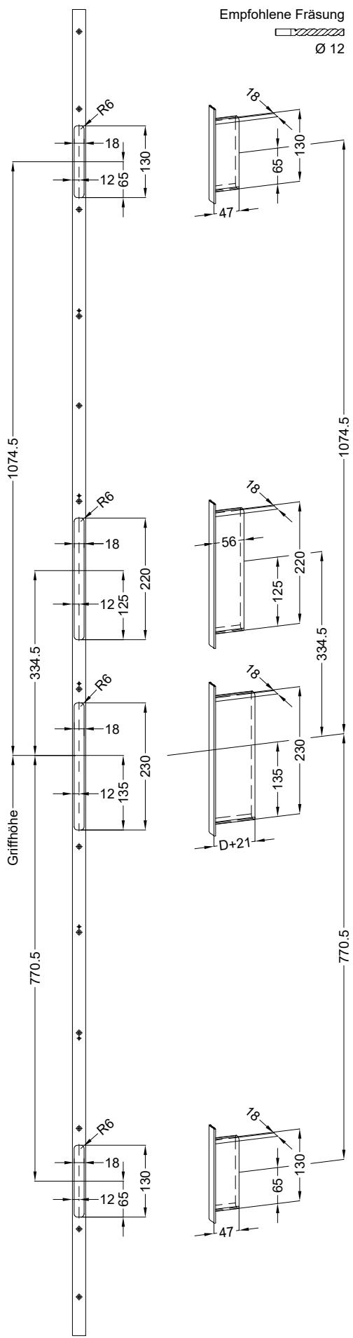
**Einbausituationen der Bauteile mit Fräsmäßen**
