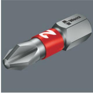
BiTorsion Bits sind absolute Premium-Bits. Mit weicherer BiTorsion-Zone, wodurch die Härte des Schaftes um ca. 20 % gegenüber der Abtriebsspitze reduziert wird. Dadurch wird das Verwinden der Bitsspitze bei auftretenden Belastungsspitzen größtenteils vermieden, was die Lebensdauer des Bits noch weiter erhöht.
