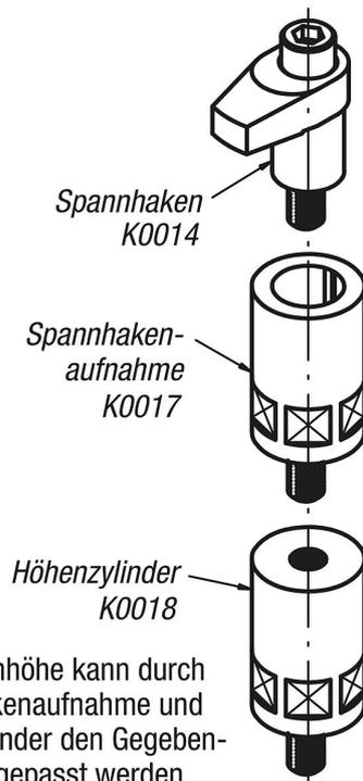
Die Spannhöhe kann durch Spannhakenaufnahme und Höhenzylinder den Gegebenheiten angepasst werden.
