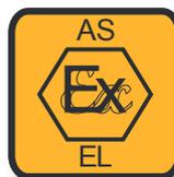
Antistatische bzw. elektrisch leitfähige Schläuche: Gemäß neuer ATEX-Richtlinie und der deutschen TRBS 2153 sollen für brennbare Schüttgüter und in explosionsgefährdeten Bereichen Schläuche mit einer ableitfähigen (antistatisch  $<10^9 \Omega$ ) oder elektrisch leitfähigen ( $<10^3 \Omega - <10^6 \Omega$ ) Wandung verwendet werden. Bitte beachten Sie die entsprechenden Vorschriften und unsere weiteren technischen Angaben.
