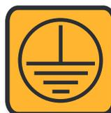
Ableitfähig: Die Schläuche, deren Spirale gemäß der neuen deutschen Technischen Regel TRBS 2153 (ehemals BGR 132) geerdet werden kann, sind mit diesem Icon gekennzeichnet.
