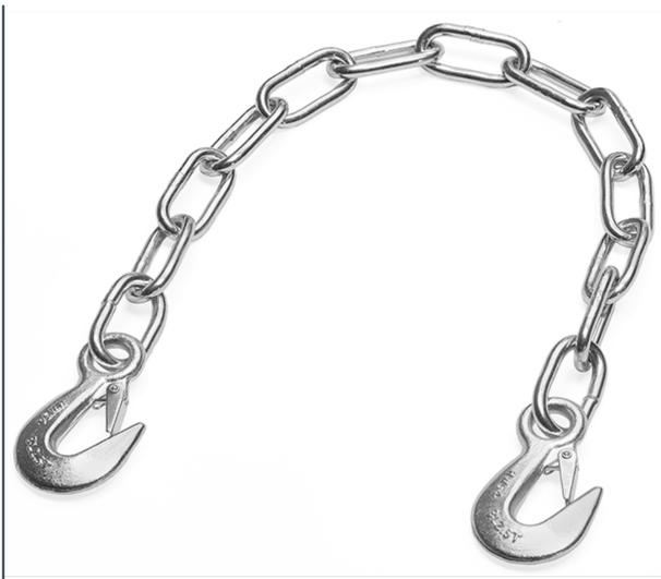
Gliederkette als Abrutschsicherung mit Abschlepphaken. Die Kette besteht aus 13 Gliedern und ist beidseitig mit Abschlepphaken ausgestattet. Die Gliedergröße beträgt 8 x 52 mm. Geprüft nach DIN 763, Bruchlast 25 KN.
