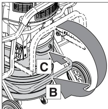
7. Schmutzbehälter (C) bis zum Anschlag in das Fahrgestell einschieben.
