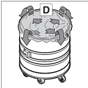
5. Entsorgungssack (D) in den Schmutzbehälter einsetzen.
