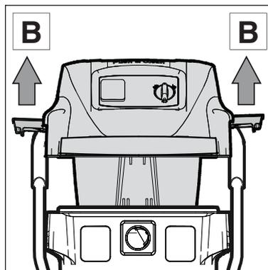
3. Verschlussklammern (B) öffnen und Saugerteil abnehmen.
