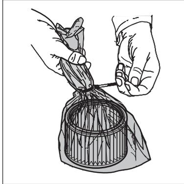
8. Filterelement vorsichtig abnehmen und Filterschutzbeutel mit einem Knoten verschließen.
