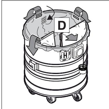
5. Sicherheits-Filtersack (D) in den Schmutzbehälter einsetzen.
