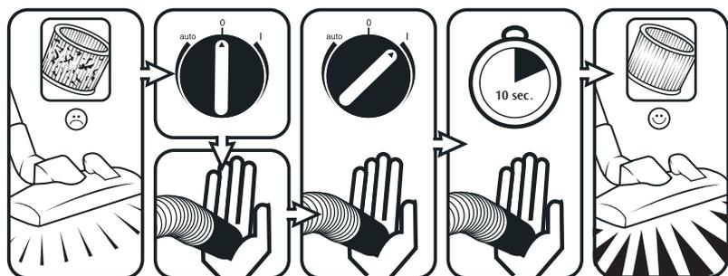
Um eine gleichbleibend hohe Saugleistung zu gewährleisten wird das Filterelement während des Betriebs automatisch abgereinigt. Bei extrem starker Verschmutzung des Filterelements empfehlen wir eine Vollabreinigung.
