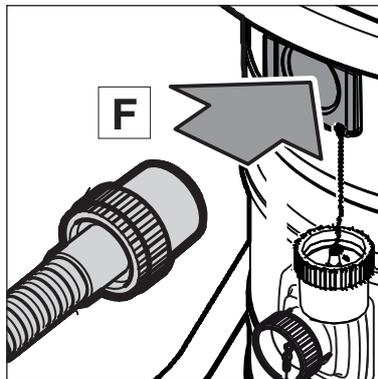
10. Saugschlauch (F) an Einlassfitting "M" (oben) anschließen.
