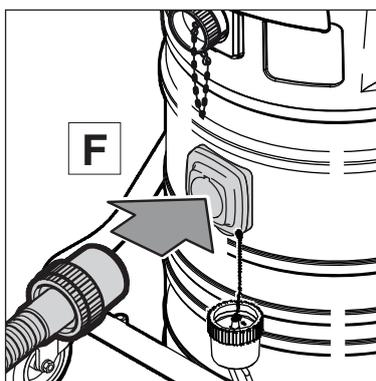
10. Saugschlauch (F) an Einlassfitting "H" (unten) anschließen.
