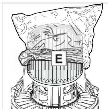
7. Filterschutzbeutel über das Filterelement stülpen.
