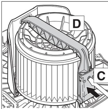
12. Filterspannscheibe (D) aufsetzen. Auf korrekte Lage achten.
