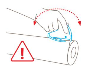
Nur **gleitend** schneiden. Metallfuß kann bei stark hebelnden Bewegungen abbrechen.
