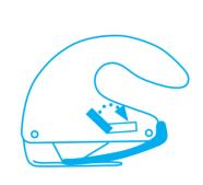
Bügel **anheben** und nach unten drehen, bis sein Ende auf dem Klingenwechselknopf aufliegt.
