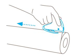
Bei Folien- und Papierbahnen mit der Spitze des Metallfußes an der gewünschten Stelle **einstechen** und schneiden.
