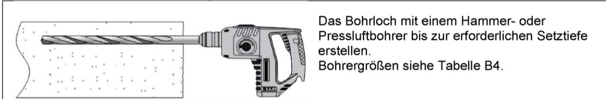
Das Bohrloch mit einem Hammer- oder Pressluftbohrer bis zur erforderlichen Setztiefe erstellen.
