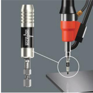
Der Impaktor Edelstahl-Halter mit Sprenging und Magnet wird den extremen dynamischen Anforderungen insofern gerecht, als dass er bewusst auf mechanisch anfälligere Kleinbauteile verzichtet. Er konzentriert sich auf die elementar notwendige Haltefunktion des Bits und die Abfederung der extremen Impulsspitzen durch zwei differente Torsionszonen. Einsatz vorwiegend in der industriellen Schraubmontage, z. B. mittels Schraubroboter.
