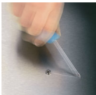
Immer wieder passiert es, dass man beim Verschrauben aus der Schraube rutscht. Manchmal werden dabei wertvolle Oberflächen beschädigt oder man verletzt sich sogar. Die Spitze von Wera Lasertip-Schraubendrehern wird mit Laserstrahlen mikroskopisch fein aufgeraut. Diese raue Oberfläche "beißt" sich förmlich im Schraubenkopf fest. Das unbeabsichtigte Herausrutschen kann damit vermieden werden.
