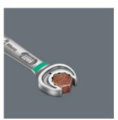
clevere Doppelsechskant-Geometrie des Jokers macht die Verbindung mit Schraube oder Mutter formschlüssig - das sitzt. Und die auswechselbare, gehärtete Metallplatte im Maul des Jokers verbeißt sich mit extrem harten Spitzen in die Schraube. verringert Beides die Abrutschgefahr auch bei hohen Drehmomenten.
