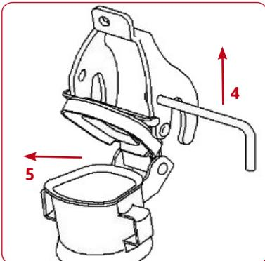
4. Heben Sie den Verschluss an und setzen Sie den Deckel auf den Stützen.
