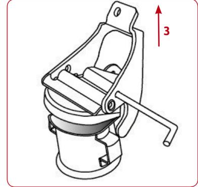
3. Öffnen Sie den Deckel durch Anheben des Verschlusses.
