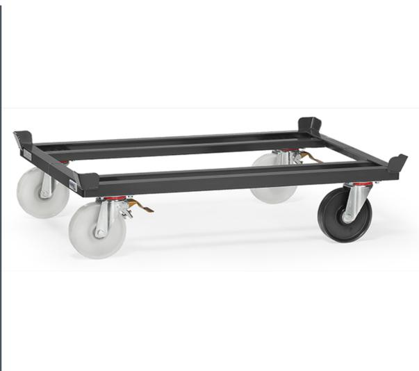
Robuste Winkelstahl-Schweißkonstruktion, mit 4 Fangecken. Pulverbeschichtet anthrazitgrau RAL 7016. 3 Lenkrollen mit Polyamid-Rädern, Naben mit Präzisionskugellager. 2 Lenkrollen mit Totalfeststeller im Vorlauf, diagonal angeordnet. 1 Rolle elektrisch leitfähig, Radkörper Polypropylen schwarz, Nabe mit Präzisionskugellager. Unterfahrhöhe: 235 mm
