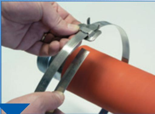
Schlaufe mit den Ohren zum Bandende auf das Band ziehen. Schelle formen, und Band auf Band legen. Schlaufe über beide Bänder ziehen, und das Bandende ca. 30 mm unter die Schlaufe biegen.
