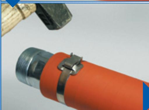
Mit einem Hammer das Band flach auf die Schlaufenbrücke schlagen, und zur Sicherung des Bandendes die beiden Ohren der Schlaufe umlegen.
