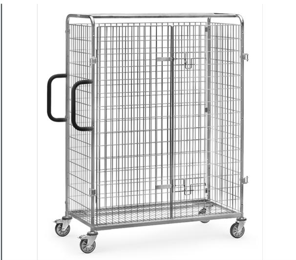
Drahtgitter galvanisch glanzverzinkt, Maschenweite 100 x 50 mm. Scharniere anschraubbar. Türflügel um 180° an den Wagenkorpus anklappbar. Je 2 Drahtbügelverschlüsse, abschließbar mittels Vorhängeschloss (nicht im Lieferumfang).
