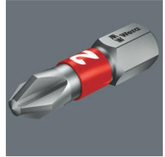
BiTorsion Bits sind absolute Premium-Bits. Mit weicherer BiTorsion-Zone, wodurch die Härte des Schaftes um ca. 20 % gegenüber der Abtriebsspitze reduziert wird. Dadurch wird das Verwinden der Bitsspitze bei auftretenden Belastungsspitzen größtenteils vermieden, was die Lebensdauer des Bits noch weiter erhöht.
