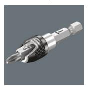
Wera Schnellwechselhalter stellen eine feste, wackelfreie Verbindung zwischen Halter und Bit her. Die Halter sind so konstruiert, dass beim Bitwechsel die äußere Hülse nach vorn geschoben wird und der Bit leicht eingesetzt und entnommen werden kann. In magnetischer Ausführung zum leichteren Ansetzen Schrauben.
