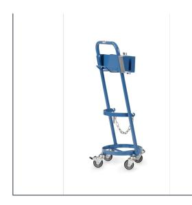
Geschweißte Stahlkonstruktion, pulverbeschichtet blau RAL 5007. Innen-Ø 310 mm. Mit Haken für Schlauchaufwicklung, Schrumpfpistolenhalter und zusätzlicher Halterung für handelsübliche Anwärm- und Abflammbrenner. 4 Lenkrollen, 2 Stück mit Feststeller, Vollgummi-Bereifung 75 x 25 mm, Naben mit Kugellager.Stahlflaschenroller
