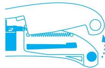
Zum Klinsenwechsel einfach den **Knopf am Griffende** drücken und die obere Griffhälfte aufklappen.
