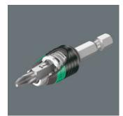
Blitzschneller Bitwechsel ohne Hilfswerkzeug. Einhandbedienung. Mit freilaufender Hülse zur leichten Führung des Schraubers. Auch in BiTorsion-Ausführung erhältlich.
