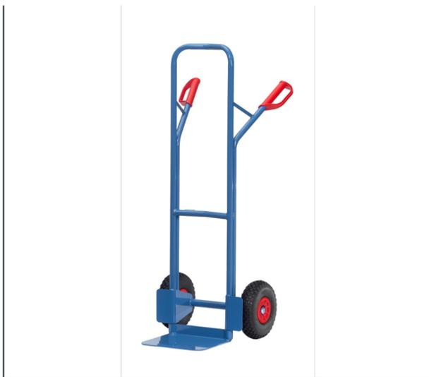
Stahlrohr-Stapelkarre mit Stahlblechschaufel, stabile Schweißkonstruktion, pulverbeschichtet, blau RAL 5007. Sicherheitsgriffe. Stahlblechschaufel anschraubbar und dadurch austauschbar. Räder mit pannensicherer PU-Bereifung, auf Kunststoff-Felgen, Naben mit Rollenlagerung. Bügel oben und Querstreben durchgebogen. Für den sicheren Transport von runden Gütern, wie Rollen, Kannen, Eimern usw. Zerlegte Anlieferung.
