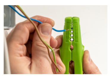
Achtung: Das Arbeiten mit WEICON Abisolierwerkzeugen ist nur an potentialfreien, nicht unter Spannung stehenden Kabeln und Leitungen zulässig.
