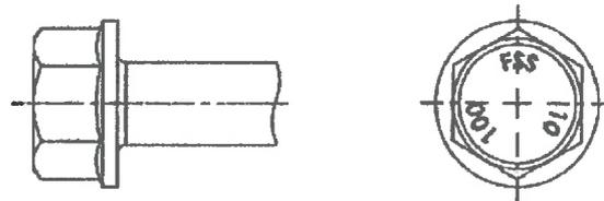
Ausführung mit angepresster Scheibe und Sechskantkopf, FSS
