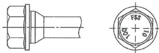
Ausführung mit angepresster Scheibe und Sechskantkopf, mit Bund, FSS C
