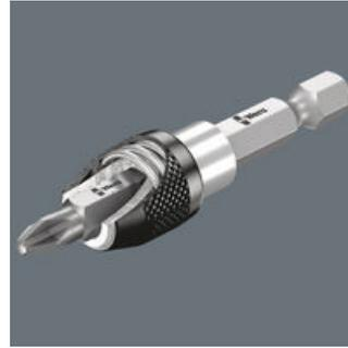
Wera Schnellwechselfutter stellen eine feste, wackelfreie Verbindung zwischen Halter und Bit her. Die Halter sind so konstruiert, dass beim Bitwechsel die äußere Hülse nach vorn geschoben wird und der Bit leicht eingesetzt und entnommen werden kann. In magnetischer Ausführung zum leichteren Ansetzen der Schrauben.
