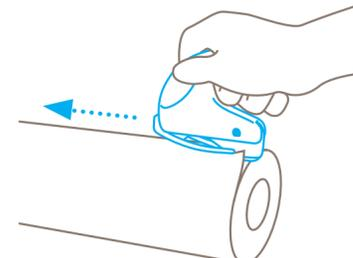
Bei Folien- und Papierbahnen mit der Spitze des Metallfußes an der gewünschten Stelle **einstecken** und schneiden.
