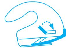
Bügel **anheben** und nach unten drehen, bis sein Ende auf dem Klingenwechselknopf aufliegt.
