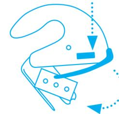
Bügel niederdrücken und Metallfuß **gleichzeitig** aus dem Griff herausziehen. Klinge wenden oder wechseln.
