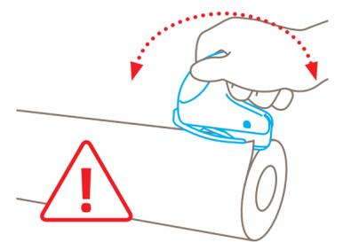
Nur **gleitend** schneiden. Metallfuß kann bei stark hebelnden Bewegungen abbrechen.
