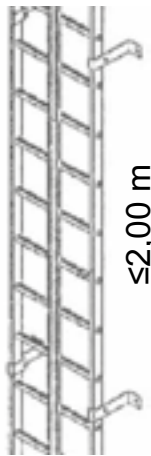
Abb. 5 Steigschutzschiene an den Sprossen einer Steigleiter bzw. Schachtleiter montiert.
