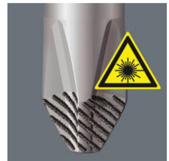
Mittels eng fokussiertem Laserlicht wird eine scharfkantige Oberflächenstruktur erzeugt. Die Laserbehandlung bewirkt eine Härte der Spuren von bis zu 1000 HV 0,3. Wera Lasertip krallt sich im Schraubenkopf fest und verhindert das Herausrutschen aus dem Schraubenkopf. Bei Schlitz, Phillips und Pozidriv.
