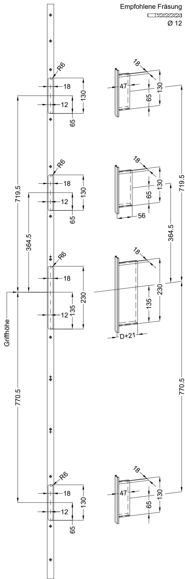
**Einbausituationen der Bauteile mit Fräsmäßen**
