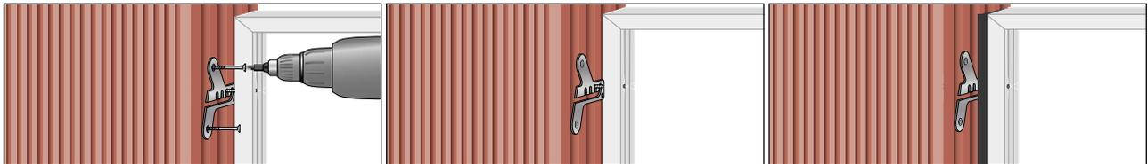
7. Die MFR-Schrauben nach dem Einhämmern bündig zum ProtectFIX einschrauben.
