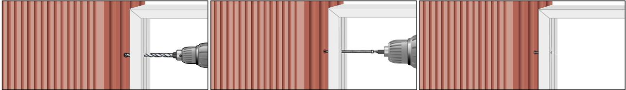
1. Fenster in die Maueröffnung stellen, ausrichten und Löcher bohren (bei Hochlochziegel und Porenbeton ohne Schlag).
