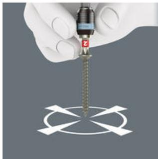
Die freilaufende Betätigungshülse erlaubt dem Anwender, den Akku- oder Elektroschrauber während des Schraubvorgangs an der Hülse zu führen. Das erleichtert das Ansetzen in der Schraube und verhindert Abrutschen. Auch als kurze Verlängerung bei 1/4" Anwendungen verwendbar z. B. in Kombination mit Wera Zyklop Knarren.
