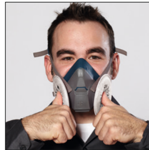
Dichstest mit Unterdruck (3M™ 6035, 6038 / Filter der Serie 2000)
