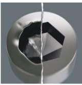
Innensechskantschrauben sind problematisch, denn die Anlageflächen, über die die Kraft vom Werkzeug auf die Schraube übertragen wird, sind sehr schmal. Die Folge: Der Schraubenkopf kann zerstört werden. Hex-Plus haben Werkzeuge größere Anlageflächen, die diese Gefahr verringern. Gut zu wissen: Hex-Plus Werkzeuge passen in jede Sta ndard-Innensechskantschraube!
