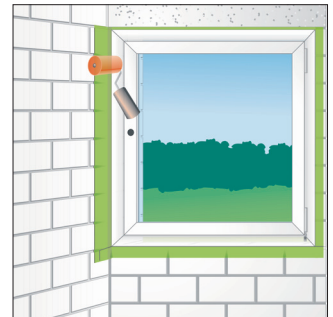
Bild 8: Folie mit Andruckroller anrollen
