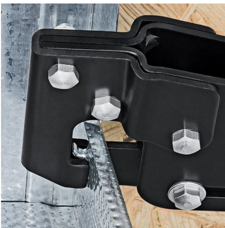
Das Stempelwerkzeug wird durch die Profilbleche gedrückt
