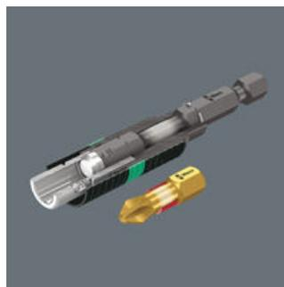
Die optimal abgestimmten Kennlinien der Torsionszonen von Bit und Halter ermöglichen ein abgestuftes Nachgeben bei Belastung. Das zweistufige System verhindert frühzeitigen Verschleiß. Darüber hinaus ist ein langes Werkzeugleben auch durch die auf die jeweilige Anwendung ausgelegte Härte der Bits garantiert.
