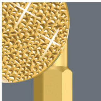
Die winzigen Diamantpartikel, die auf der Werkzeugschulter aufgetragen sind, beißen sich förmlich in der Schraube fest und sorgen für einen passgenauen und rutschfesten Sitz im Schraubenkopf. Durch diesen sicheren Sitz wird die Schraube geschont. Die Cam-Out-Kräfte (Ausrutschkräfte), die den Anwender zwingen, hohen Druck auf die Schraube auszuüben, werden erheblich reduziert.
